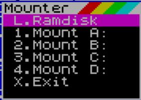
При выборе монтирования для TRD образа буквы виртуального и реального дисковода будут изменены на букву которая будет выбрана при монтировании с соответствующей перезаписью CMOS.
