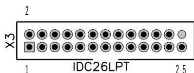
Разъем предназначен для подключения принтера (рекомендуется использовать EPSON совместимый принтер).
