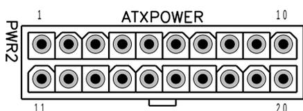
Разъем предназначен для подачи питания на плату ZX Evolution при использовании стандартного ATX блока питания.
