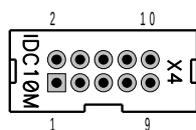
Разъем предназначен для программирования FPGA EP1K50Q208 по интерфейсу JTAG с помощью программатора ByteBlasterMV или любого другого, поддерживающего указанный интерфейс. Нумерация разъема идет от квадратной площадки.
