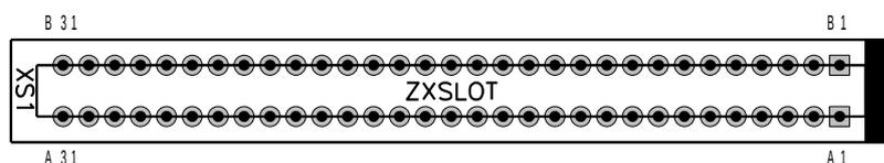
Шаг контактов ZXBUS — 2.54мм. Будьте осторожны при установке плат производства 90-ых годов и ранее, у них шаг 2.5мм.
