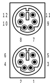
Разъем предназначен для подсоединения PS/2 клавиатуры и мыши. Клавиатура подключается в ближнее к плате гнездо разъема, мышь подключается в дальнее от платы гнездо.
