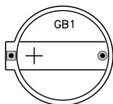
Предназначен для установки батарейки для питания энергонезависимой памяти и часов (PCF8583).
