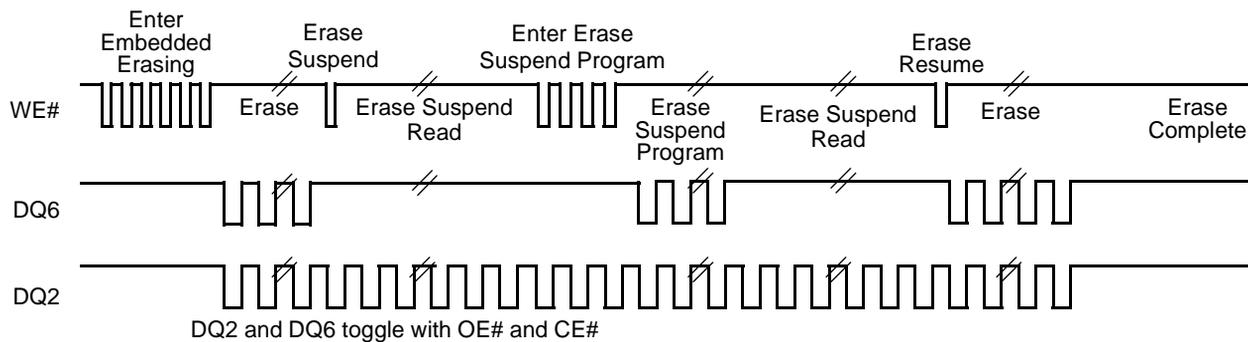
**Note:** Both DQ6 and DQ2 toggle with OE# or CE#. See the text on DQ6 and DQ2 in the section “Write Operation Status” for more information.
