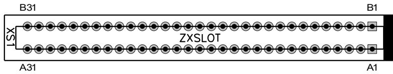
Шаг контактов ZXBUS — 2.54мм. Будьте осторожны при установке плат производства 90-ых годов и ранее, у них шаг 2.5мм.
