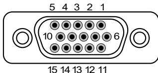
Разъем предназначен для подключения монитора или телевизора, оснащенного VGA разъемом.
