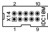
Разъем предназначен для программирования периферийного контроллера ATMEGA128 по интерфейсу JTAG ICT с помощью программатора, поддерживающего указанный интерфейс.
