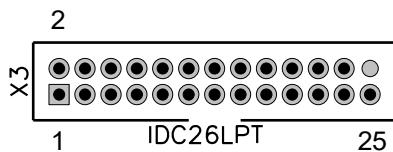
Разъем предназначен для подключения принтера (рекомендуется использовать EPSON совместимый принтер).
