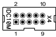
Разъем предназначен для программирования FPGA EP1K50Q208 по интерфейсу JTAG с помощью программатора ByteBlasterMV или любого другого, поддерживающего указанный интерфейс.
