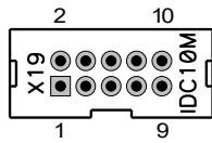
Коммуникационный порт предназначен для соединения с другим компьютером либо с коммуникационным оборудованием (например, с модемом). Поддерживает скорость до 115200бод.
