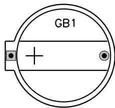
Предназначен для установки батарейки для питания энергонезависимой памяти и часов (PCF8583).
