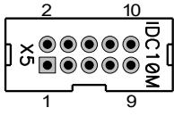
Разъем предназначен для программирования периферийного контроллера ATMEGA128 по интерфейсу ISP с помощью программатора ByteBlasterMV или любого другого, поддерживающего указанный интерфейс.
