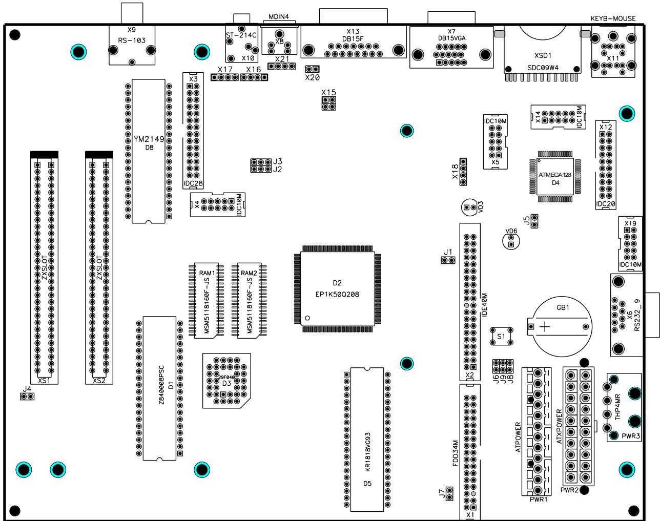
Плата оснащена отверстиями для крепления в корпус miniATX согласно спецификации. Также основные рабочие разъемы для подсоединения периферии расположены в «окне» ATX корпуса, что облегчает установку платы и доступ к разъемам.
