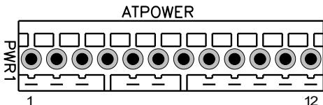
Разъем предназначен для подачи питания на плату ZX Evolution при использовании стандартного AT блока питания.
