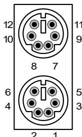
Разъем предназначен для подсоединения PS/2 клавиатуры и мыши. Клавиатура подключается в ближнее к плате гнездо разъема, мышь подключается в дальнее от платы гнездо. Корпус разъема соединен с землей.
