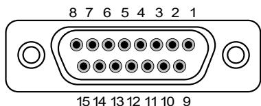
Разъем предназначен для подсоединения телевизора или монитора по SCART или RGB видео стандарту.
