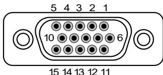
Разъем предназначен для подключения монитора или телевизора, оснащенного VGA разъемов.
