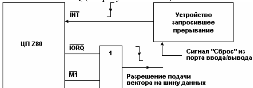
Рис. 6.6. Подача запроса на прерывание и формирование сигнала подтверждения прерывания
